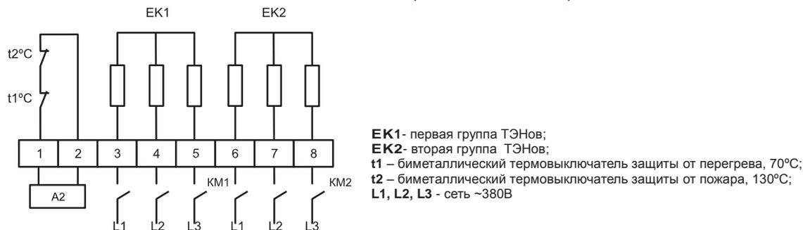
**Схема подключения ЭНП-3**
