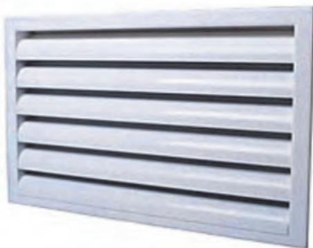
Наружные решетки предназначены для подачи и удаления воздуха в системах вентиляции, кондиционирования и воздушного отопления. Конструктивно наружные решетки серии РН состоят из рамы и неподвижно закрепленных жалюзи S-образной аэродинамической формы. Решетки изготавливаются из легкого алюминиевого сплава и имеют прочную конструкцию. Решетки окрашены порошковым покрытием, как правило, в белый цвет, RAL 9016. При специальном заказе окраска возможна в любой другой цвет по каталогу RAL.
