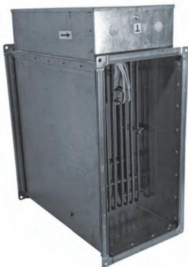
Корпус воздухонагревателей серии EHR изготовлен из оцинкованной листовой стали. Нагревательные элементы сделаны из нержавеющей стали. Перед установкой в воздухонагреватель каждый нагревательный элемент проходит заводское тестирование, в том числе тестирование электрической изоляции.
