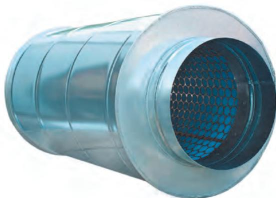
Шумоглушители серии ГТК конструктивно представляют собой две трубы вставленных одна в другую. Наружная труба гладкая, а внутренняя — перфорированная. Пространство между ними наполнено звукопоглощающим материалом. Размеры внутренней трубы равны размерам воздуховода, куда установлен шумоглушитель.
