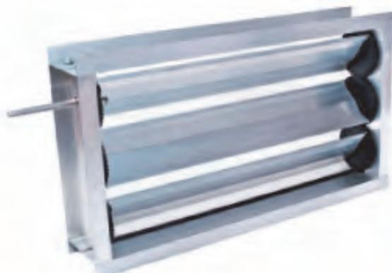
Воздушные клапаны предназначены для настройки расхода воздуха в канале, регулирования и наладки систем вентиляции, а также для перекрытия каналов во время остановки работы системы вентиляции. Клапаны изготовлены из алюминиевого профиля. Лопатки оснащены резиновым уплотнителем. Клапаны могут поставляться как с ручным приводом, так и с сервоприводом.
