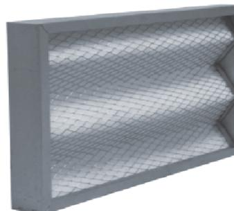
Фильтры кассетные состоят из корпуса изготовленного из оцинкованного металла и кассеты в которой расположен фильтрующий синтетический материал класса очистки G3, опирающийся со стороны входа на сетку гофрированной формы.
