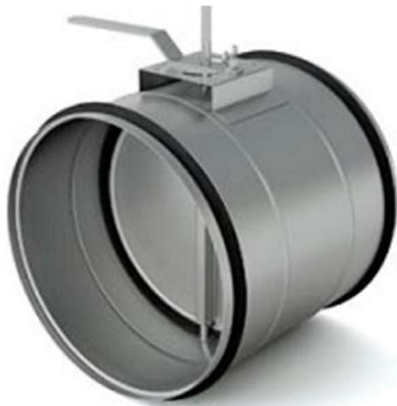
Воздушные клапаны для круглых каналов систем вентиляции серии КVK предназначены для настройки расхода воздуха в канале, регулирования и наладки систем вентиляции, а также для перекрытия каналов во время остановки работы системы вентиляции. Корпус и заслонка изготовлены из оцинкованной стали. Запорные лопатки оснащены резиновыми уплотнениями, повышающие степень герметичности в закрытом положении. Клапаны оснащены площадкой для установки сервопривода и ручкой регулировки положения лопатки.
